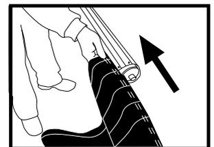
12. Setzen Sie den Markisenstoff, parallel zu Schritt 13, wieder entlang der Spur in die Rolle ein.
