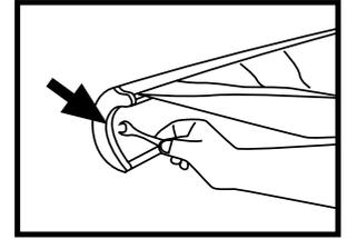
4. Lösen Sie auch die Schraube, die sich in der Mitte der Vorderstangenabdeckung befindet.
