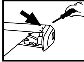
3. Entfernen Sie eine weitere Schraube, die sich oben rechts auf der Vollkassette befindet. Sie haben nun insgesamt 3 Schrauben.
