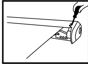
2. Lösen Sie die zwei Schrauben auf der rechten Seite der Vollkassette
