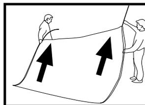
10. Entfernen Sie die zwei langen Stäbe aus den Seiten des Markisenstoffes.
