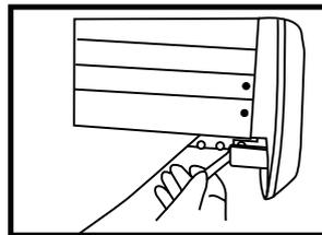
6. Lösen Sie die Schraube, die die rechte Abdeckung fixiert. **HINWEIS:** Die Schraube lässt sich nicht ganz entfernen, sondern nur lockern.
