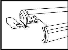
1. Ziehen Sie die Markise mit Hilfe der Kurbel oder eines Schraubenziehers manuell aus. Die Markise muss vollständig ausgefahren sein.
