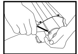
8. Lösen Sie nun den Schraubstift, der sich am Ende der Markisenrolle befindet. Diese fixiert den Markisenstoff.
