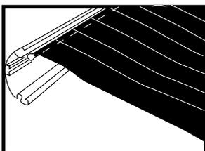
13. Schieben Sie den Markisenstoff, parallel zu Schritt 12, wieder in die Vorderstange der Markise.
