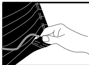
11. Nehmen Sie die zwei Stäbe und führen Sie diese durch die beiden Enden des neuen Markisenstoffes.
