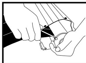
14. Wenn der neue Markisenstoff eingesetzt ist, ziehen Sie bitte die Schraubstifte an. Somit ist der Stoff fixiert.
