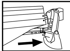
7. Nehmen Sie die Abdeckung der Vollkassette ab. **HINWEIS:** Die untere Schraube sitzt ziemlich fest. Daher wird es wahrscheinlich mehr Kraft in Anspruch nehmen, die Abdeckung abzuführen.
