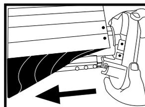
15. Stecken Sie die Abdeckung wieder an das Ende der Vollkassette. **HINWEIS:** Stellen Sie sicher, dass die Abdeckung richtig bzw. in einer Linie eingesetzt ist und richtig einklickt. Am besten ist es dabei, den unteren Schraubstift zuerst einzuschieben.
