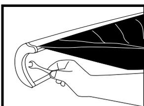
17. Stecken Sie schließlich auch die Abdeckung wieder auf und fixieren Sie diese mit den Schrauben.
